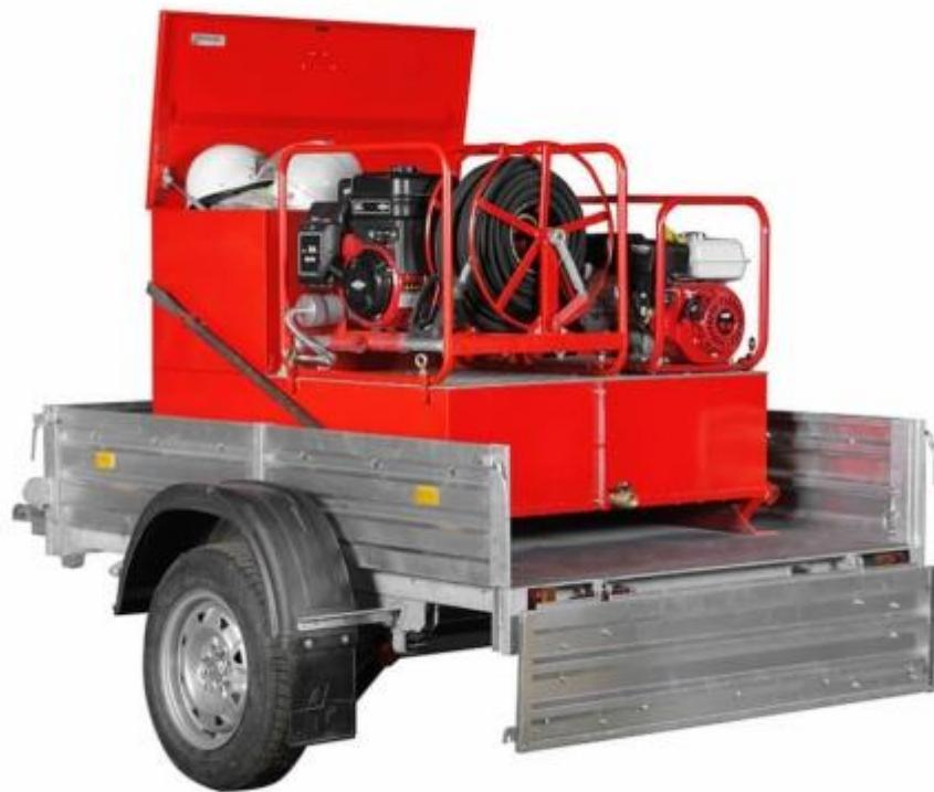
Мобильный универсальный пожарный модуль МУПМ-300 (далее МУПМ-300) или эквивалент предназначен для патрулирования, проведения необходимых противопожарных работ, связанных с предупреждением и тушением лесных пожаров, а также использования для локализации и ликвидации возгораний в сельских населенных пунктах.
