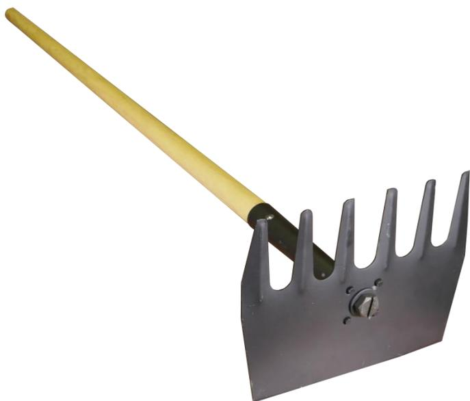
Комбинированный ручной инструмент грабли-мотыга применяется при создании минерализованных полос в процессе тушения лесных пожаров.
